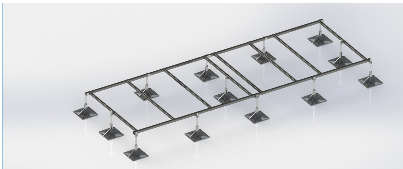
coolFRAME - Sonderlösung mit zusätzlicher Unterstützung der Querstreben
