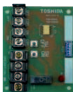
Leistungsspitzenabschaltung Steuerplatinsensor TCB-PCDM4E
