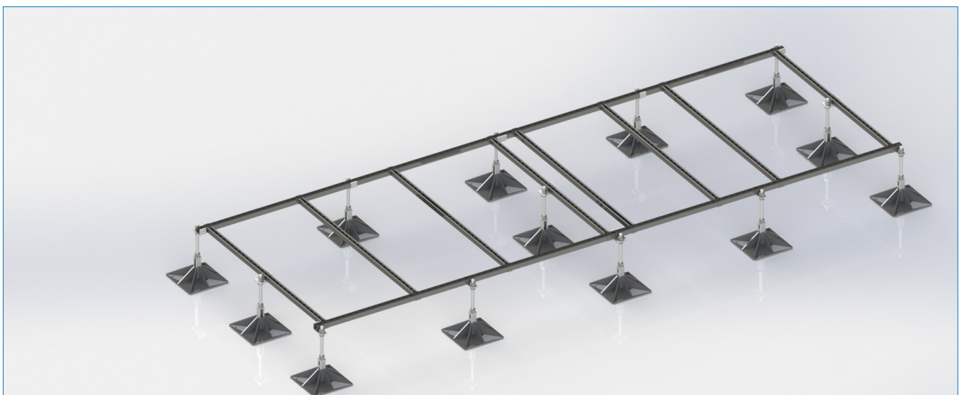
coolFRAME - Sonderlösung mit zusätzlicher Unterstützung der Querstreben
