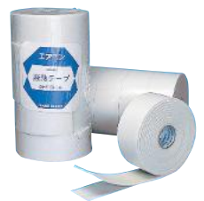
Material: Chemisch vernetztes, 30-fach geschäumtes Polyethylen (JIS A9511 A-PE-C-2 Standard/ Isolationswärmebeständigkeit bis 120°C)
